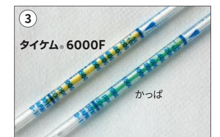
タイケム® 6000F側の検知管に変化はないが、かっぽ側の検知管が変色しているのがわかる。
