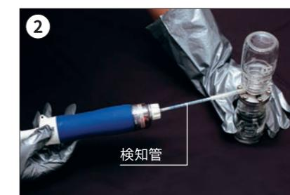
化学物質に反応して黄色から緑色に変化する検知管を空瓶側につなぎ、瓶内部の空気を抜く。
