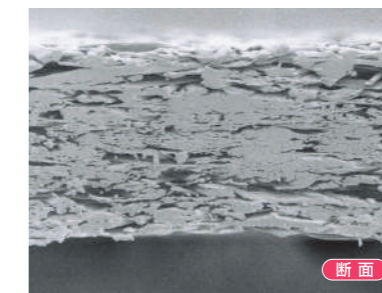
タイベック®を構成する強靱な極細ポリエチレン繊維(約300倍)
